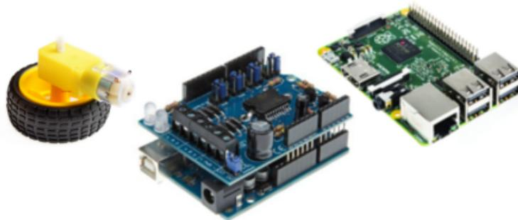
FIGURE 1 – RaspberryPi2 , carte Arduino avec un shield et moteur
